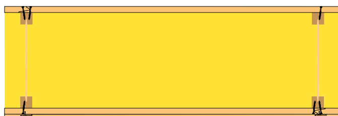
Fig 6.1. Konstruktion bestående av 22 mm Forestia Golv, Masonite Beams I-balk, mineralull, 22 mm Forestia Golv och Tak-ess
